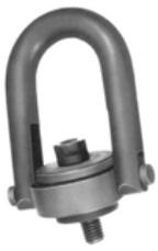
Die Nenntragfähigkeit von Schulterösen wird bei gewinkelten Aufhängungen erheblich herabgesetzt. Wenn eine Anwendung einen Montagewinkel von mehr als 45° erfordert, muss ein drehbarer Anschlagwirbel oder ein ähnliches Anschlagmittel verwendet werden. Diese Anschlagmittel sind voll dreh- und
